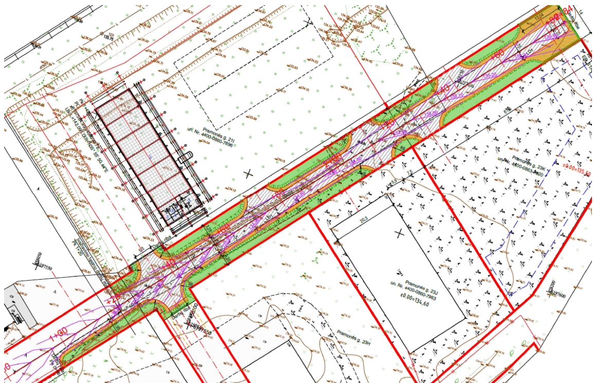
3.6.1 pav. Tęsinio ir nuovažų planas Nagrinėjamame ruože važiavimo greitis 30 km/h.
